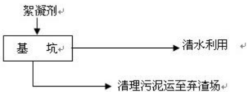
图 8-3 基坑废水处理工艺流程图
